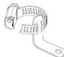
Obrázek 9 Příchytka stroje k podlaze
